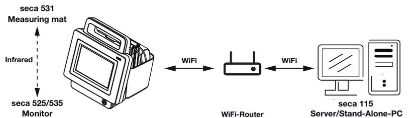
Wenn Sie das Gerät als WiFi-Client mit Ihrem Netzwerk verbinden, kann die Messmatte -falls vorhanden- ausschließlich über die Infrarotschnittstelle mit dem Monitor kommunizieren.
